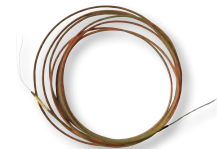
高压 K 型热电偶 CN042 NEW ※测量超过 300 V 的温度时，请使用高压 K 型热电偶 CN042。CN042 前端为双层绝缘，可直接安装在 1500 V 的被测物上。
